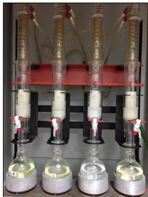
Slika 10. Aparat za ekstrakciju masti po Soxhletu
