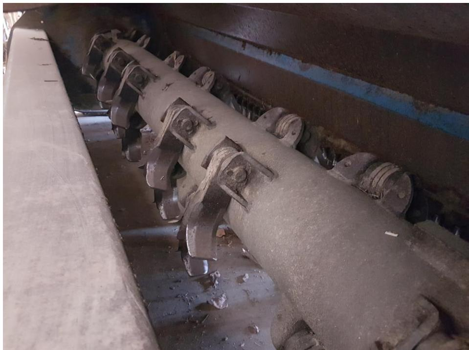
Slika 7. Čekići na osovini malčera
