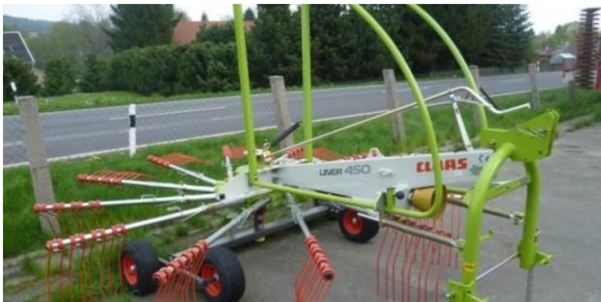
Slika 8. Rotacijske grablje sa tandem podvozjem marke Class
