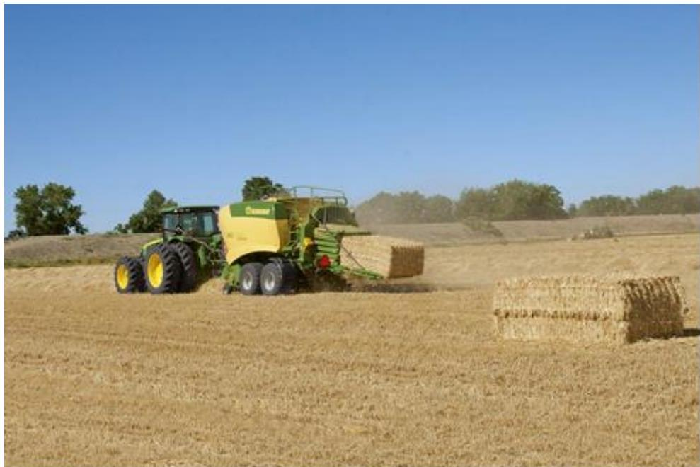
Slika 14. Preše za velike četvrtaste bale
