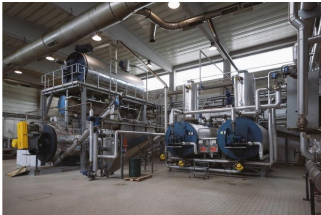
Slika 2.10. Preradbeni dio (sterilizatori, sušara) Izvor: Agroteinika d.d.
