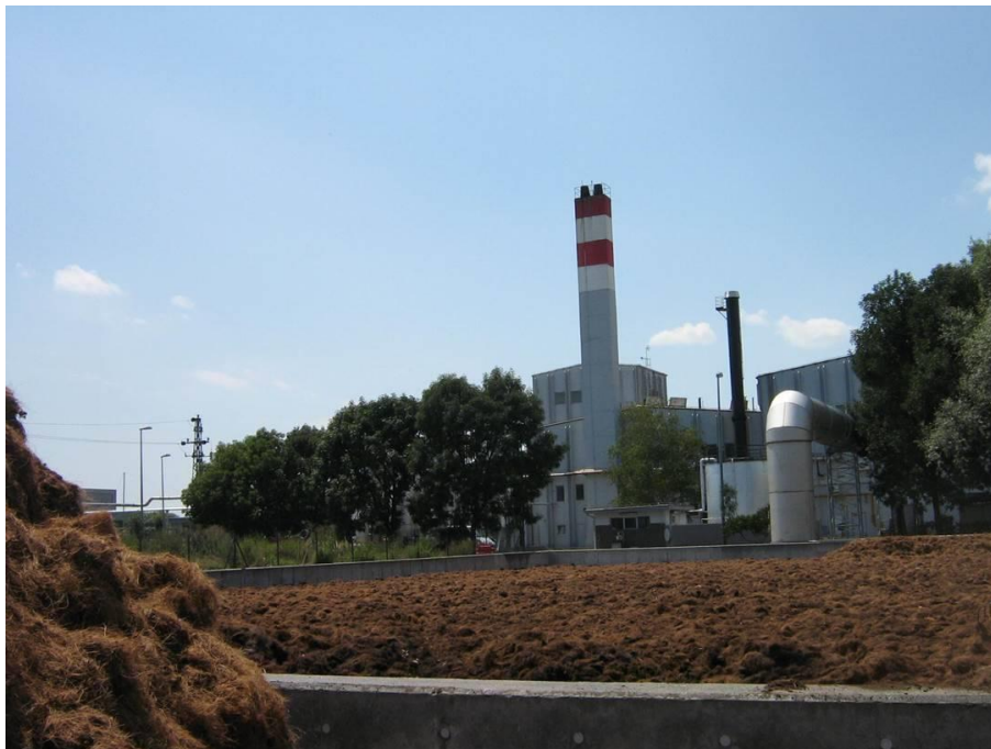
Slika 2.12. Biološki pročišćivač zraka (kokosova vlakna)
