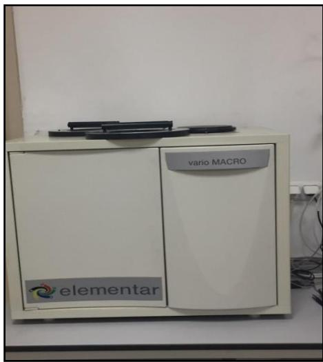
Slika 29. CHNS analizator (Izvor:
