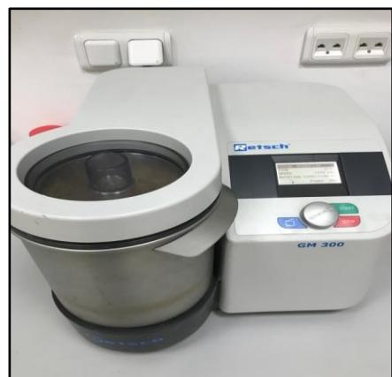
Slika 26. Laboratorijski mlin Retsch GM 300 (Izvor: Božidar Matin – vlastita arhiva)
