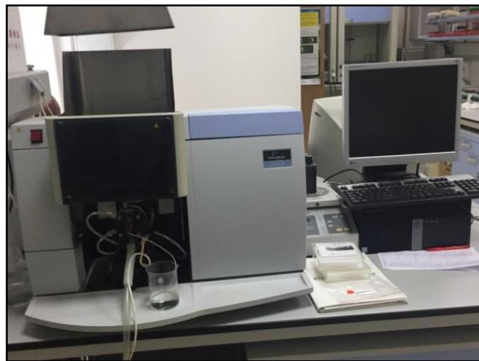
Slika 31. Atomski apsorpcijski spektrometar (Izvor:
