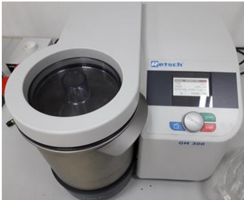
Slika 2. Laboratorijski mlin korišten za usitnjavanje rezidbenih ostataka
