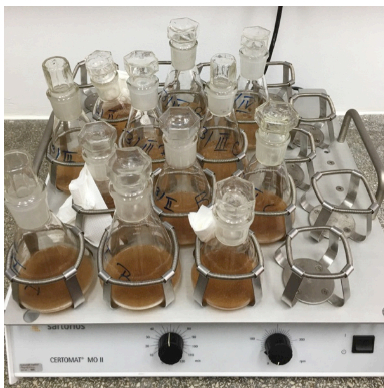
Slika 4.5.6. Miješanje uzorka na tresilici
