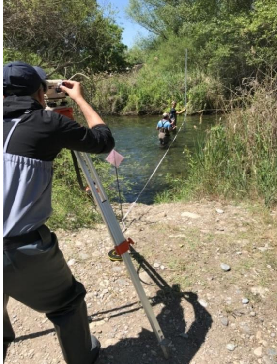
Očitavanje podataka uz pomoć optičkog mjerača na stalku Izvor: Prof. Jorge Alcázar
