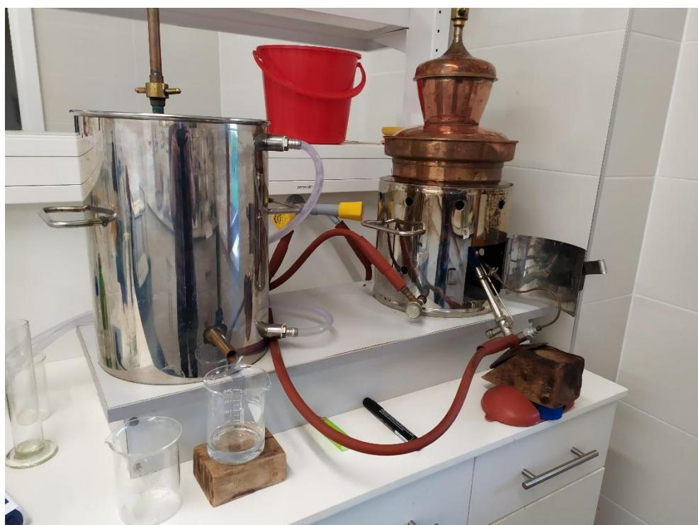
Slika 5.3.1. Jednostavni destilacijski uređaj kapaciteta 5L
