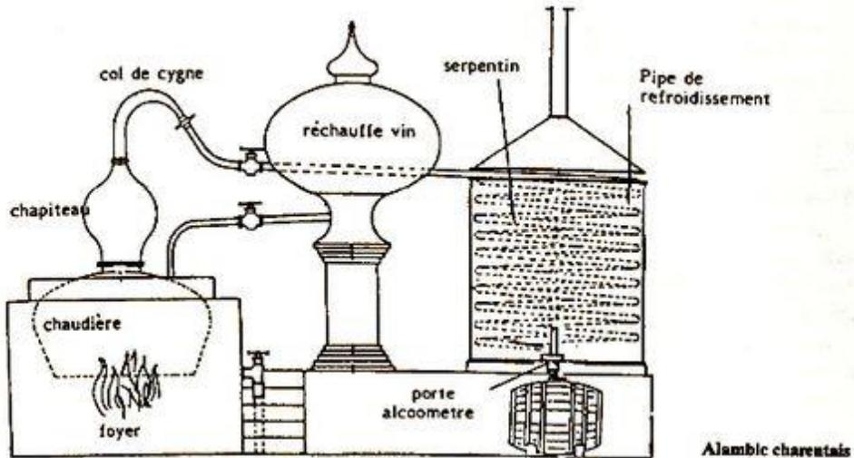
Slika 3.2. Dijelovi *alambic charentais*
