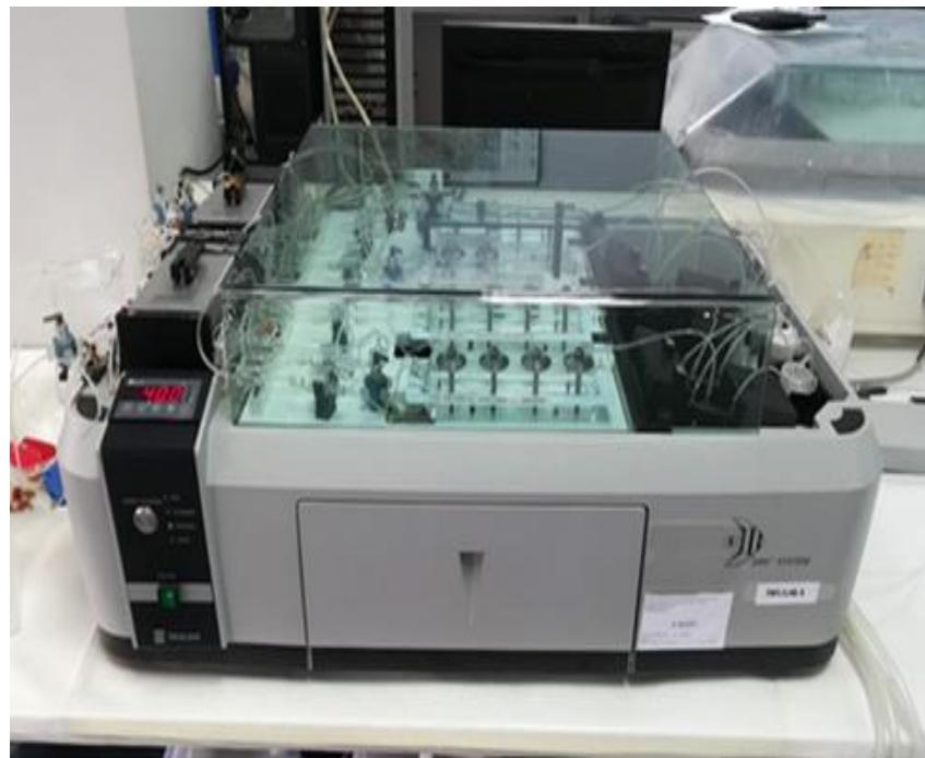
**Slika 3.4.2.** Analizator kontinuiranog protoka u MELILAB-u.
