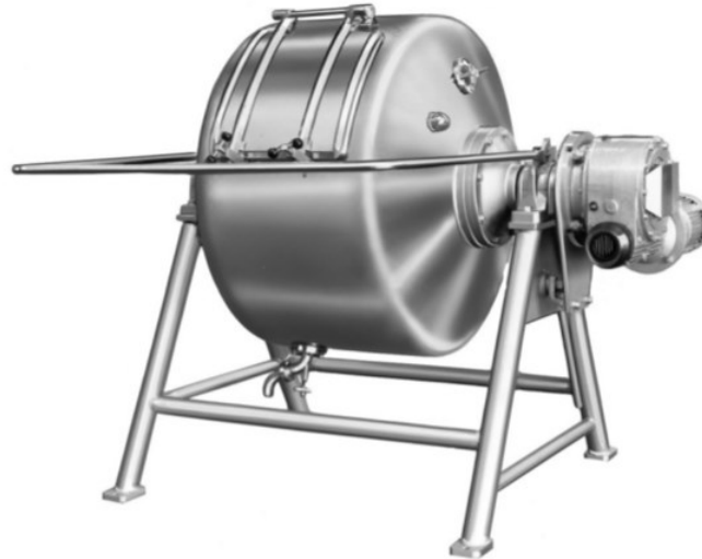
Slika 4.1. Prikaz bučkalice za diskontinuiranu proizvodnju maslaca (Izvor: Fearon, 2011.)
