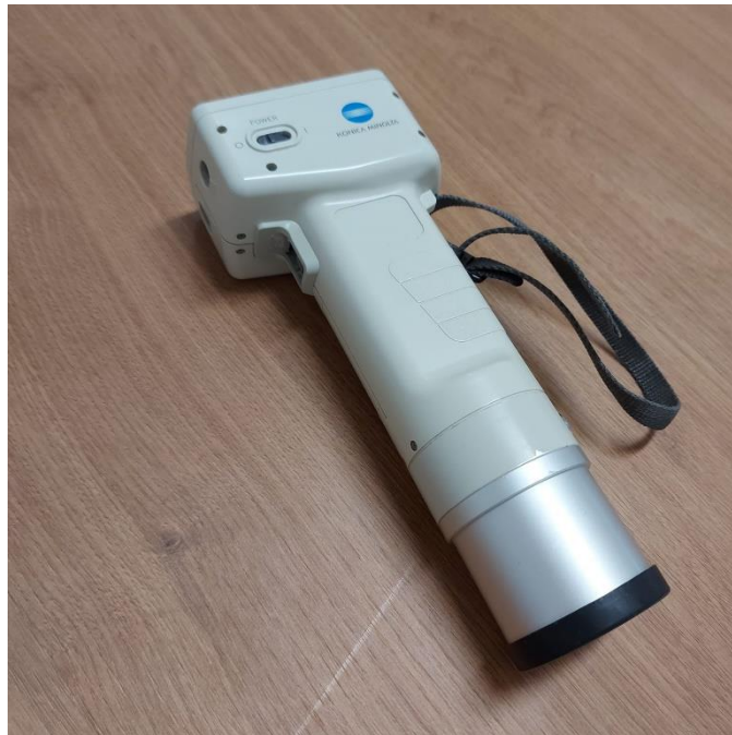
Slika 3.3.1.3.1. Uređaj korišten za mjerenje instrumentalne boje
