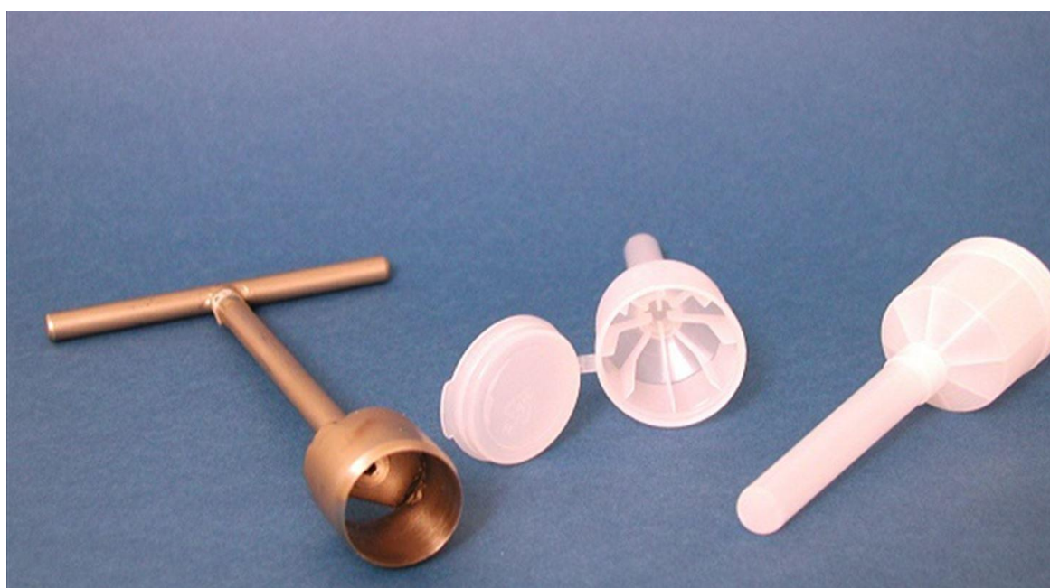
Slika 3.3. Sonda i spremnici za uzorke mesa
