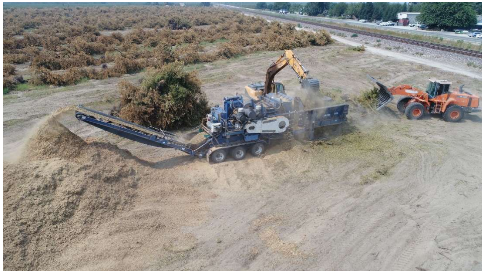
Slika 4. Usitnjavanje uklonjene biomase na mjestu uklanjanja
