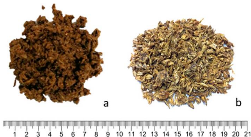
Slika 17. a) uzorak tropa prije sušenja b) uzorak tropa nakon sušenja (Arranz J i sur.)
