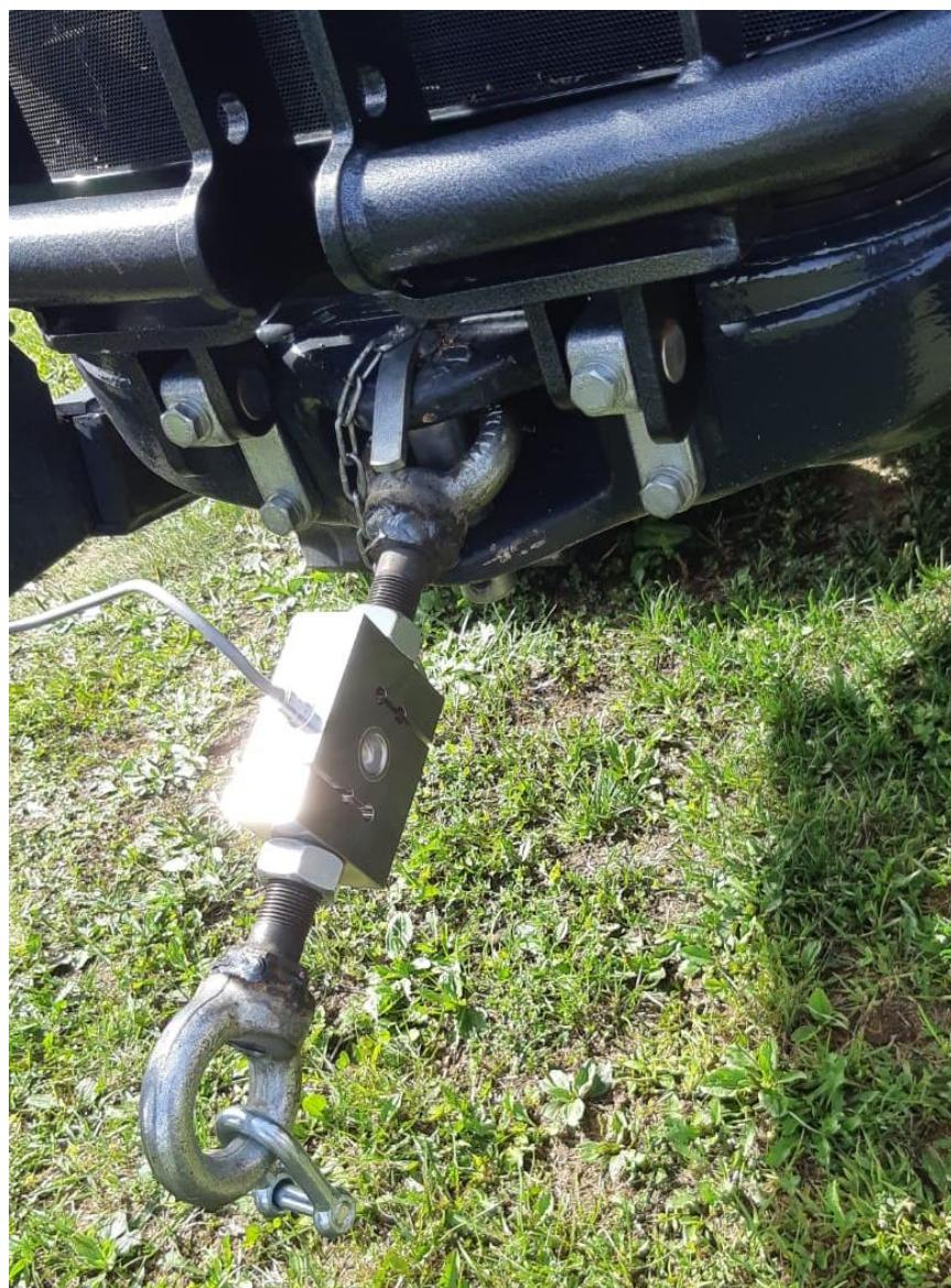
Slika 3.6. Dinamometar DHBМ – S9M/50 kN
