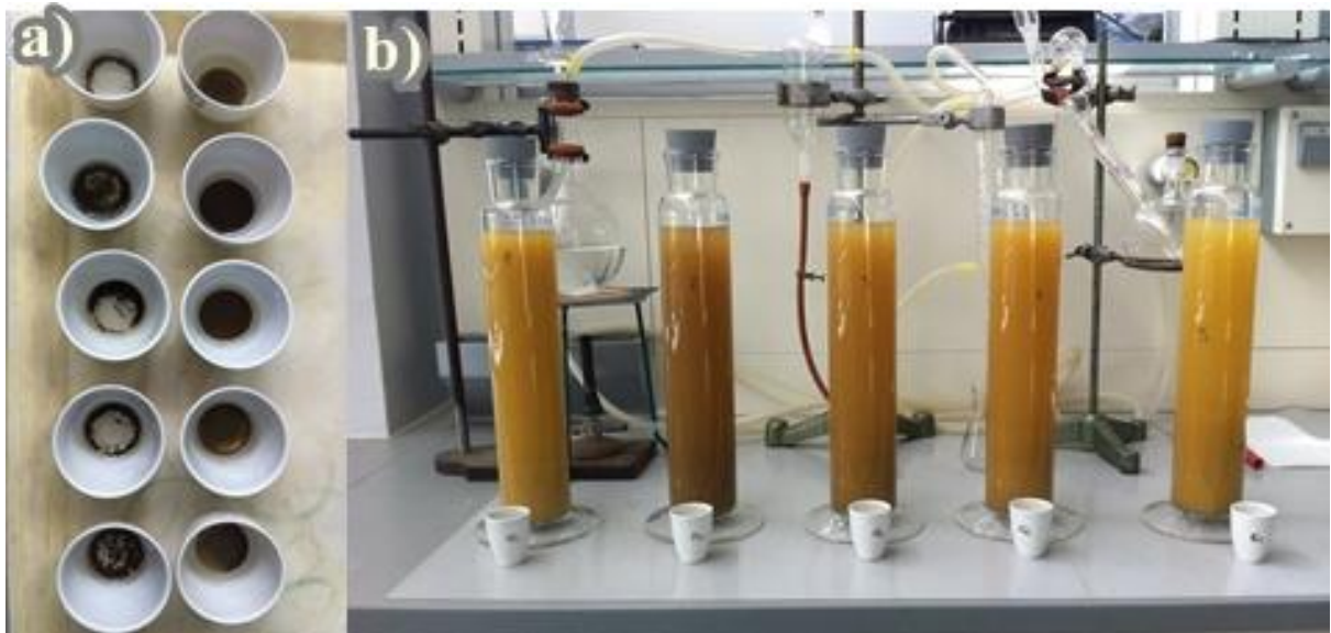
Slika 3. - Određivanje Mehaničkog sastava tla. a) lončići sa krupnim i sitnim pijeskom; b) cilindri sa prahom i glinom
