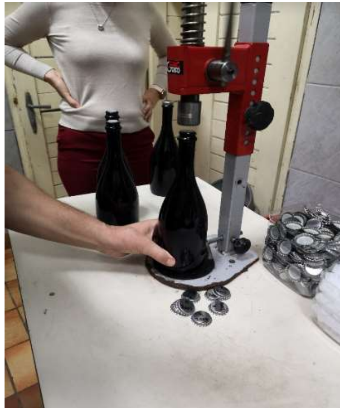
Slika 2.5. Postavljanje krunskih čepova Izvor: Šikač I.
