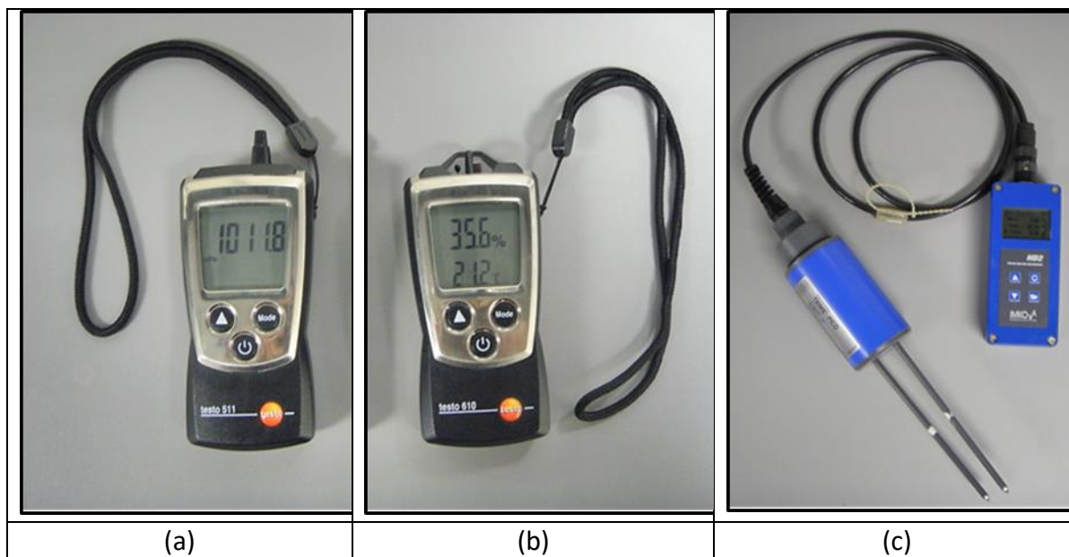
Slika 2.6.1. Uređaji za utvrđivanje agroekoloških uvjeta. (a) Testo 511 (2011); (b) Testo 610 (2011); (c) IMKO HD2 (sonda Trime – Pico64, 2011).
