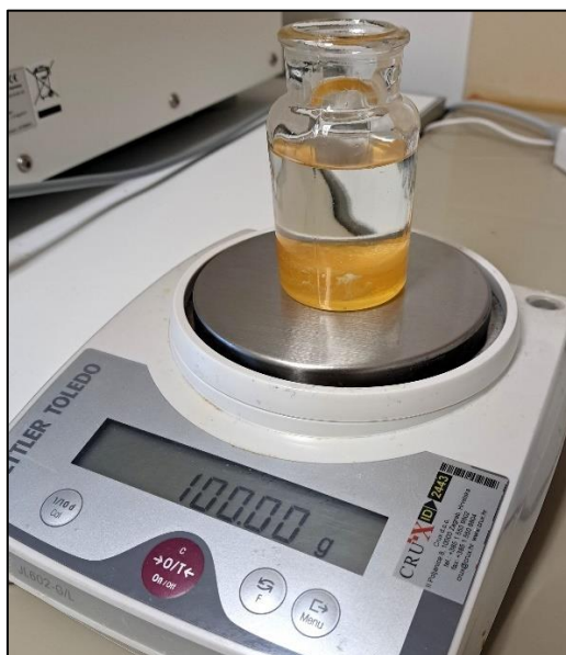
Slika 8. Priprema uzorka meda za utvrđivanje električne provodnosti
