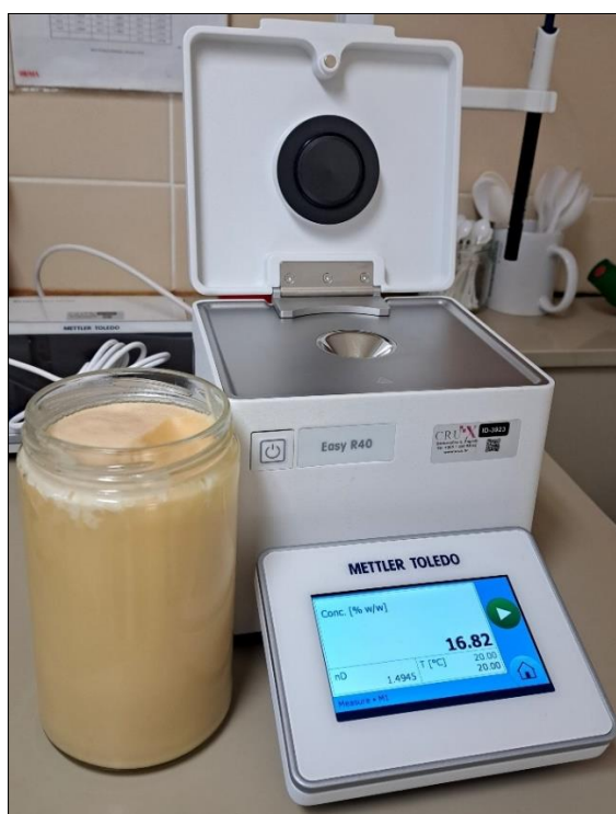
Slika 7. Utvrđivanje udjela vode stolnim refraktometrom
