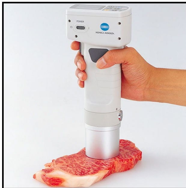
Slika 2.3 : Uređaj za mjerenje boje mesa Izvor: https://sensing.konicaminolta.asia/
