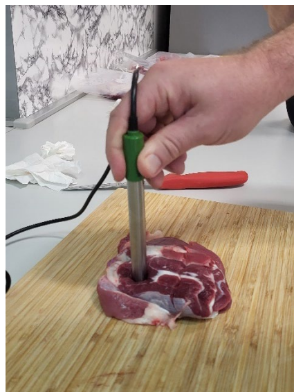
Slika 3.3.(lijevo) uređaj HI -98191 za mjerenje pH mesa, Slika 3.4. (desno) mjerenje pH mesa
