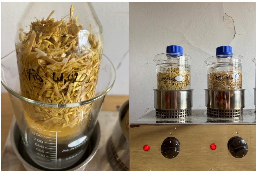
Slika 12. Izbjeljivanje uzoraka smjesom vodikova peroksida i ledene octene kiseline
