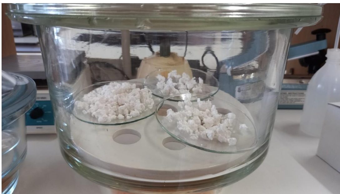
Slika 15. Posušeni uzorci energetskih kultura nakon tretmana sa NaOH skladišteni u eksikatoru
