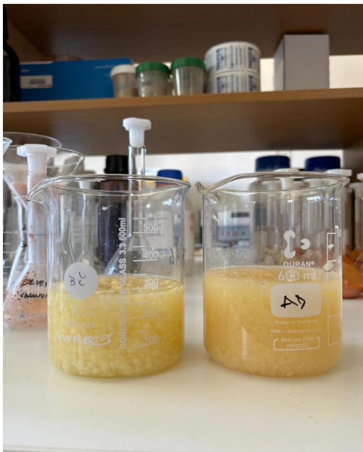
Slika 14. Smjesa uzorka i natrijeve lužine
