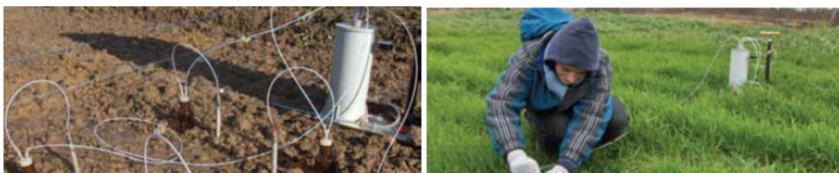
Slika 21 Sakupljanje otopine tla u polju pomoću mikro usisnih čašica, odnosno sustava za uzorkovanje koji se sastoji od keramičke porozne sonde smještene u tlo na željenoj lokaciji i dubini (Čidić et al., 2008).
