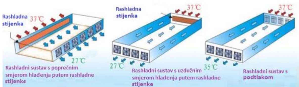
Slika 6. Prikaz načela rada rashladnog sustava s podtlakom
