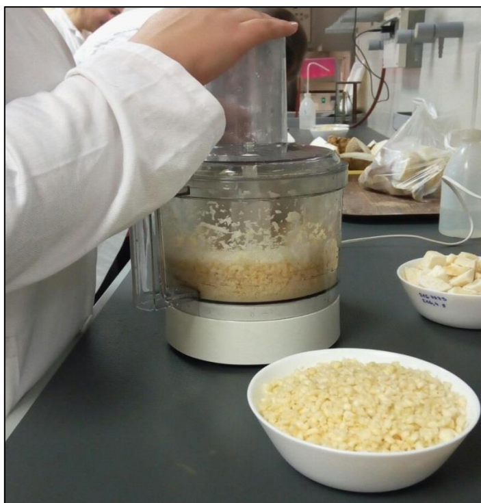
Slika 3.2.3. Usitnjen uzorak nakon mljevenja, spreman za sušenje Autor: Jurišić, 2016
