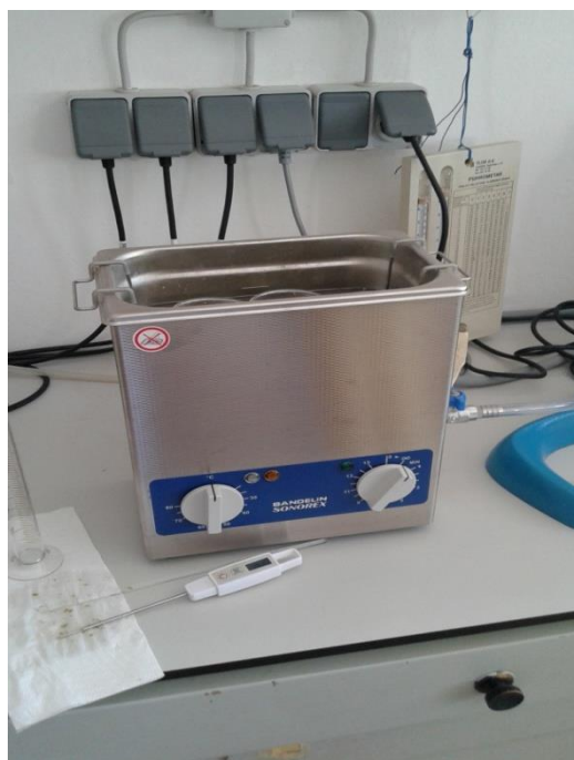
Slika 12. Ultrazvučna kupelj „Bandelin“ RK 103H (Foto: Maja Pleša, 2017)
