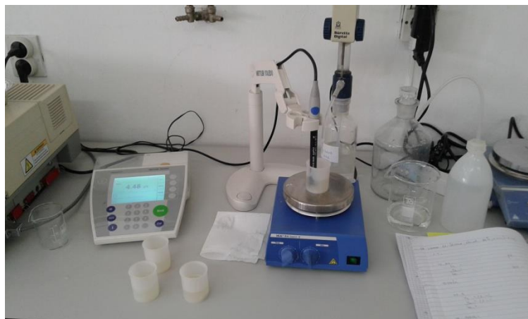
Slika 14. Određivanje pH vrijednosti (Foto: Maja Pleša, 2017)
