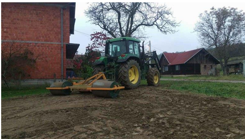
Slika 4. Valjanje površine (Foto: Maja Pleša, 2017)
