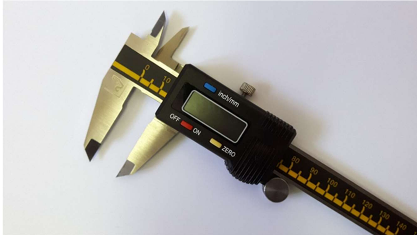
Slika 3.6.2. Mjerenje dužine i širine digitalnom pomičnom mjerkom.
