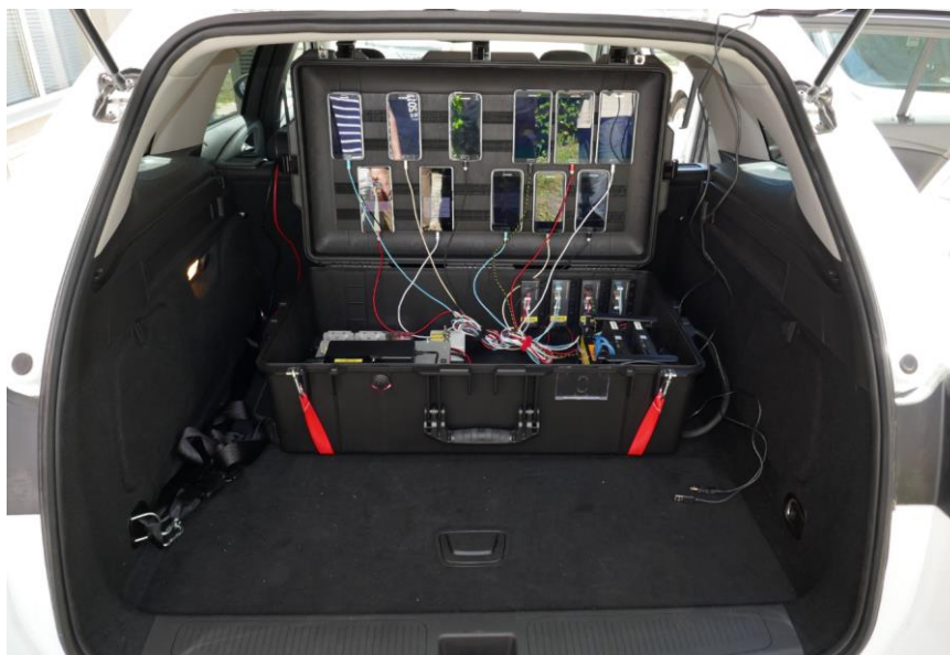
Slika 4.3.2 Instalacija mjernog sustava za drive test pomoću mjernih terminala
