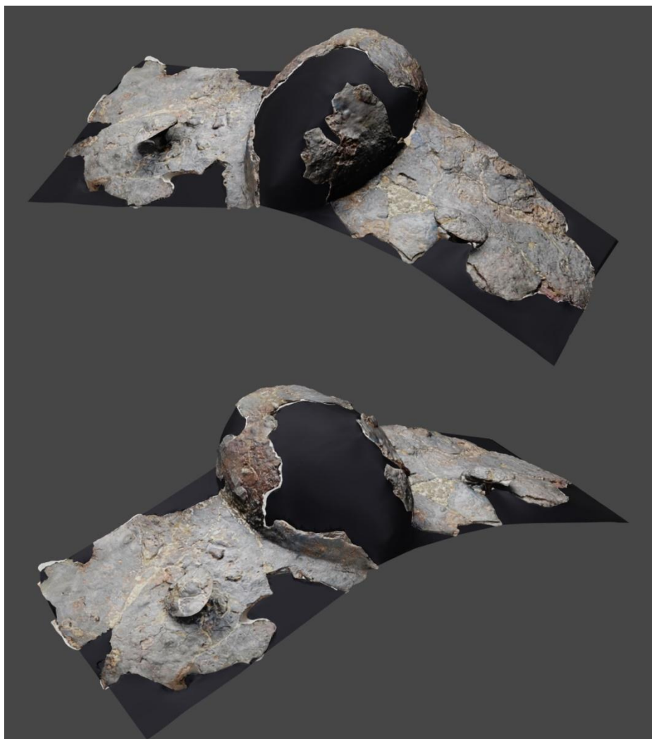
Slika 21. 3D vizualizacija nedostajućih dijelova umba štita, izradio: B. Erdelji 2023.
