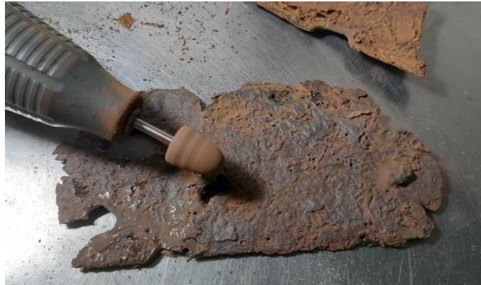
Slika 30. Detalj brušenja smole mikromotorom, snimio: R. Erdelji 2022.
