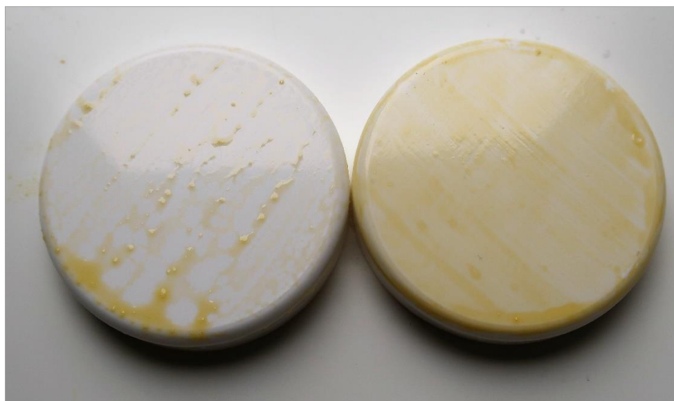
Sl. 31. Sloj cijelog jajeta nanešen na podloge; lijevo: jajce nanešeno na hladnu podlogu – skupljanje veziva, desno: jajce nanešeno na toplu podlogu – postignuta veća ravnomjernost
