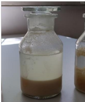
Sl. 32. Močenje kazeina u destiliranoj vodi
