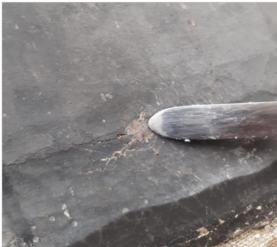
Slika br. 77, fotografija prikazuje nadoknadu u sloju osnove na izvorniku
