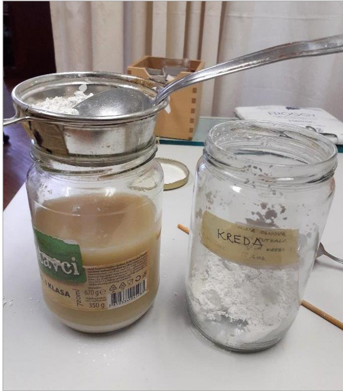
Slika br. 43, izrada kredno-tutkalne osnove 7%-tnim tutkalom i mješavinom bolonjske i šampanjske krede
