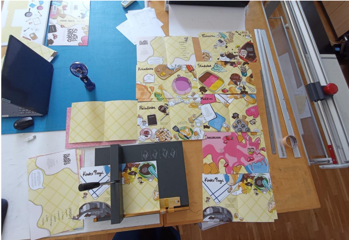
Slika 38. Prikaz procesa rezanja i bigovanja stranica
