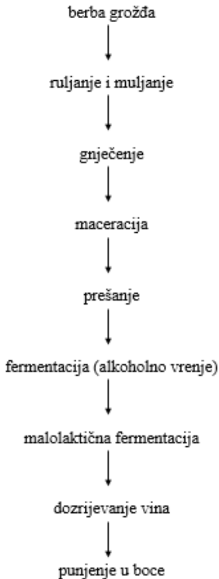
Slika 5 Shematski prikaz proizvodnje vina od branja grožđa do punjena vina u boce
