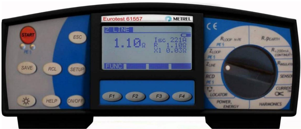
Slika 5.5. Display mjernog instrumenta „METREL“
