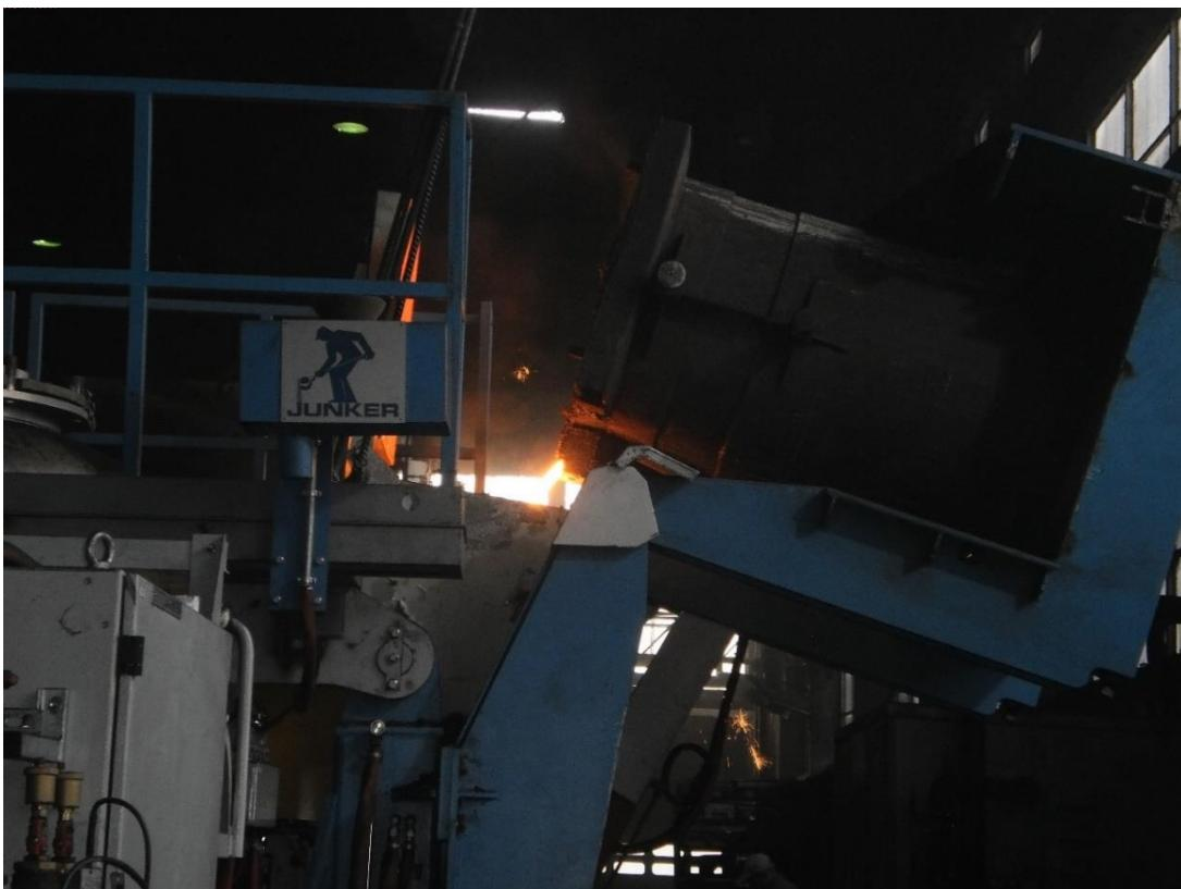
Slika 4.3. Lijevanje taline iz ljevačkog lonca u agregat za lijevanje (fotografirano 5.2.2016)
