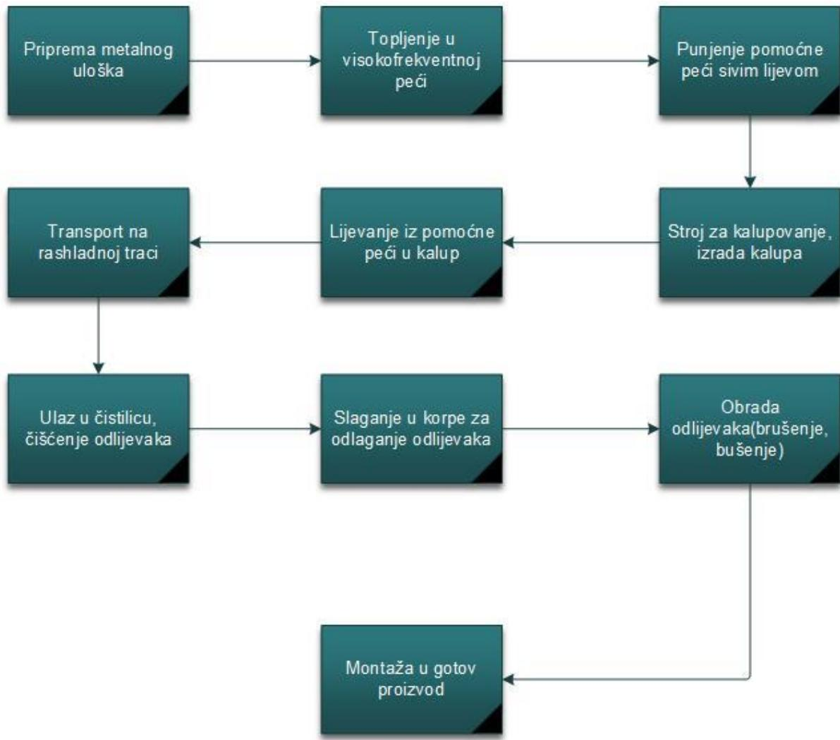
Slika 3.1. Dijagram toka procesa proizvodnje peći
