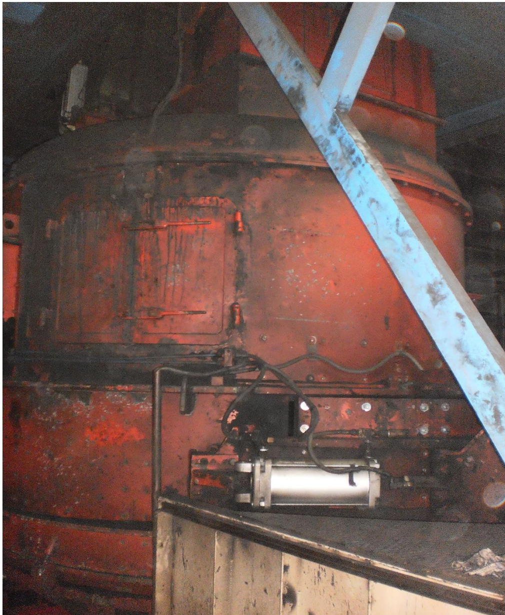
Slika 5.1. Mješalica za pripremu pijeska (fotografirano 5.2.2016)
