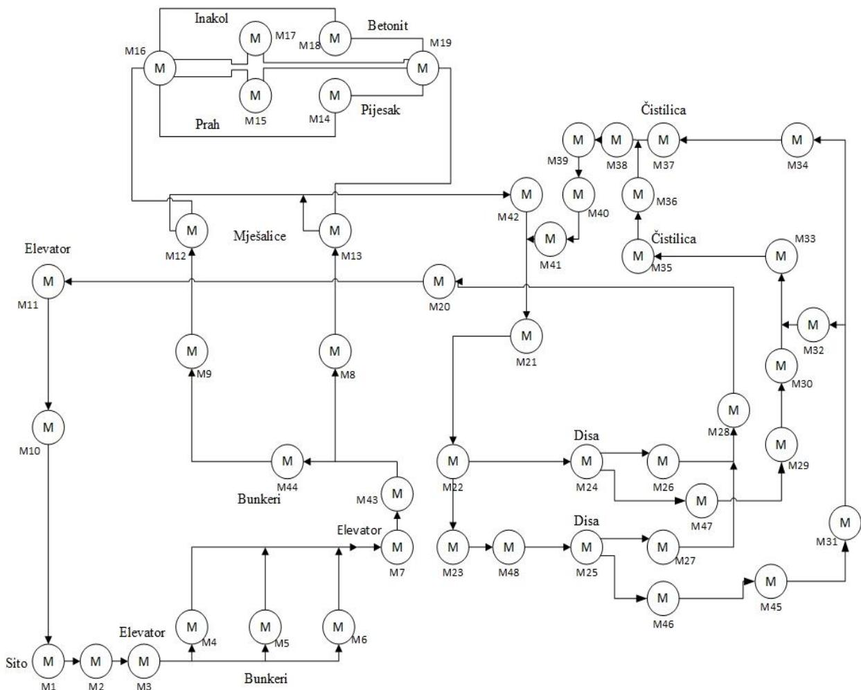
Slika 12.1. Jednopolna shema motora
