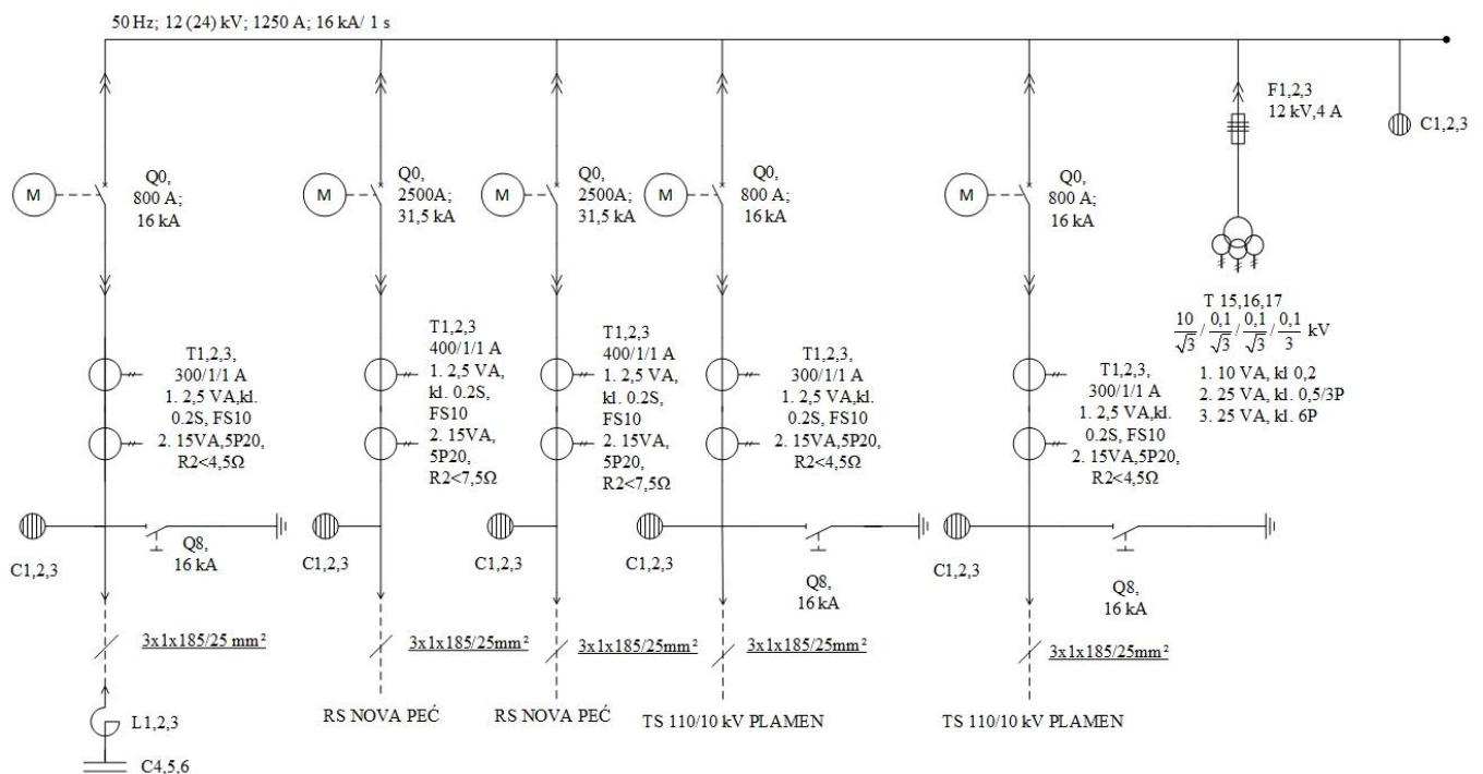
Slika 9.1. Jednopolna shema RS 10 kV NOVA PEĆ [12]
