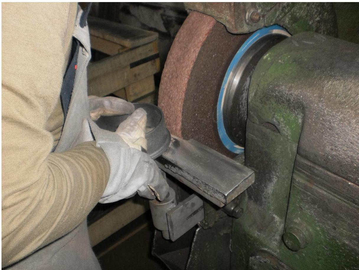
**Slika 7.1.** Brušenje odlijevka (*fotografirano 5.2.2016*)
