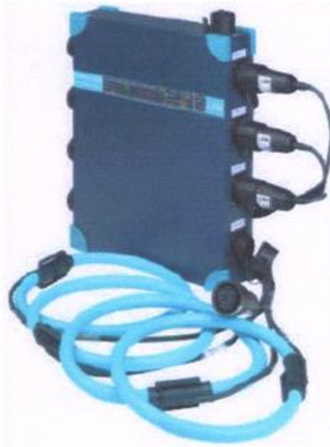
Slika 3.5. Uređaj za mjerenje kvalitete električne energije LEM-FLUKE TOPAS 2000 u klasi A, [14].
