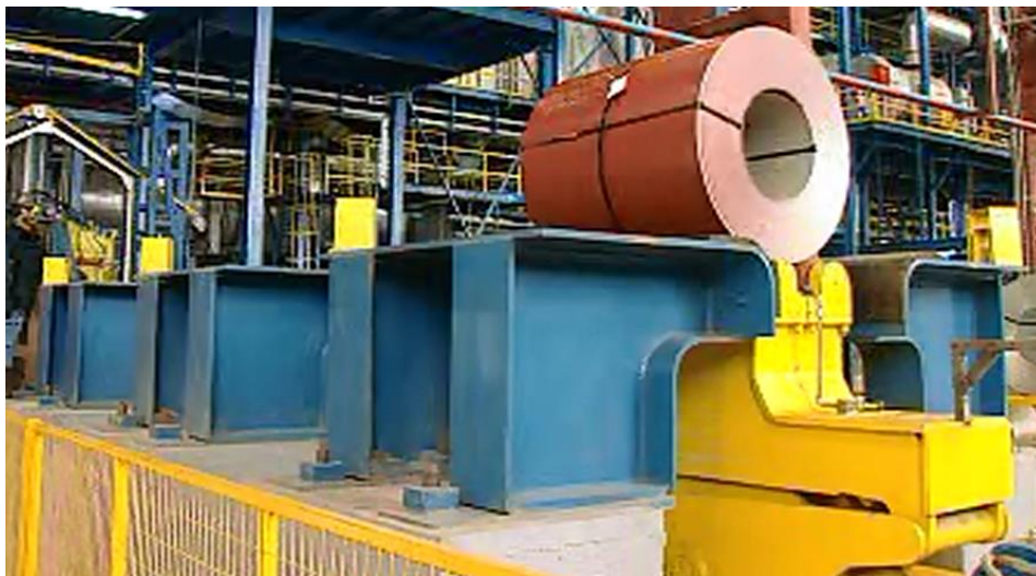
Slika 3.2. Namotaj se pozicionira na određenu poziciju
