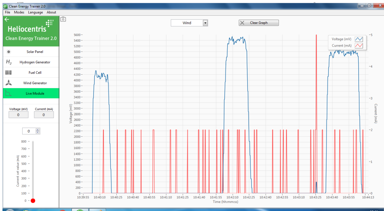
Slika 4.2. Ovisnost broja elisa o generiranom naponu
