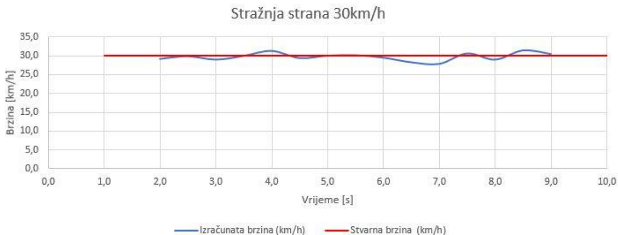
Slika 4.57. Prikaz brzine za stražnju stranu automobila pri brzini 30km/h
