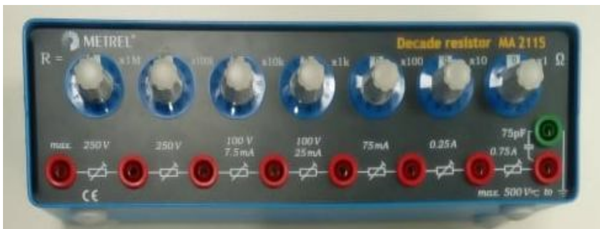
Slika 3.3. Otporna dekada MA 2115
