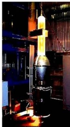
Slika 5.3. Postupak aksijalne depozicije [2].
