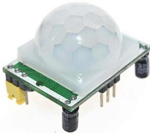
Slika 2.4. PIR senzor koji se koristio u projektu.
