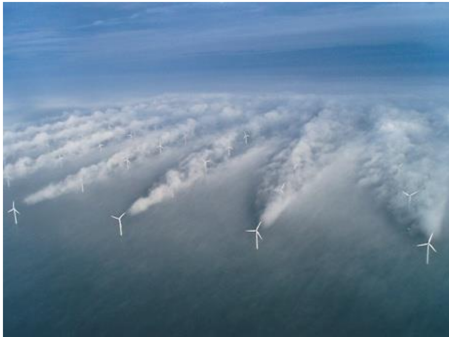
Sl. 4.12. Efekt međusobnog zaklanjanja (zavjetrine) [21]
