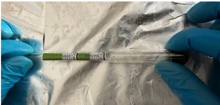
Slika 6.5. Temperaturna ljestvica s plovkom na dnu
