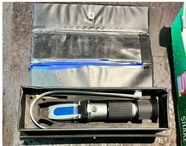
Slika 6.2. Refraktometar BAHCO 3046-REF
