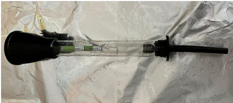
Slika 6.4. Hidrometar s plovkom
