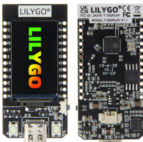
Slika 4.2. LilyGo TTGO Display razvojna ploča
