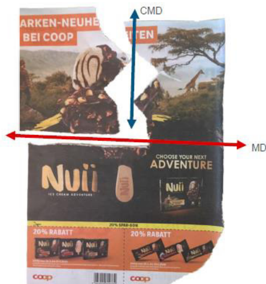
Slika 6 Praktičan primjer orijentacije vlakna [7]
