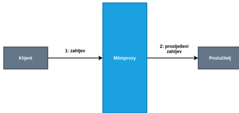
Slika 4.3 Eksplicitno preusmjeravanje HTTP prometa, preuzeto iz [10]
