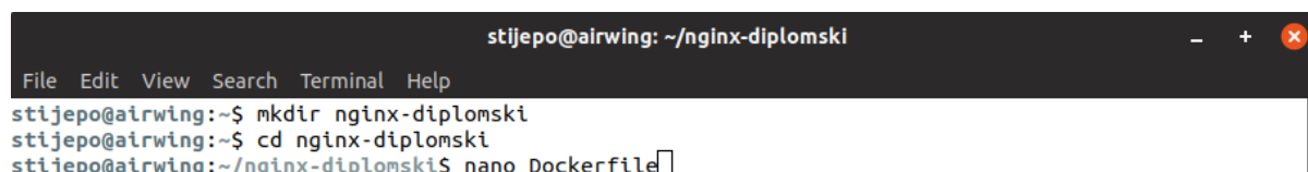
Slika 12. Kreiranje mape nginx-diplomski i datoteke Dockerfile
