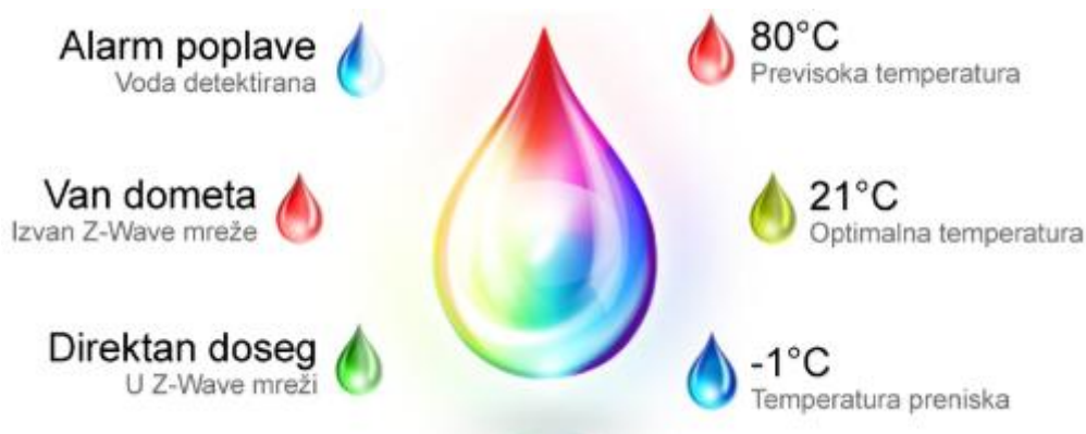
Slika 22. LED indikator senzora poplave
