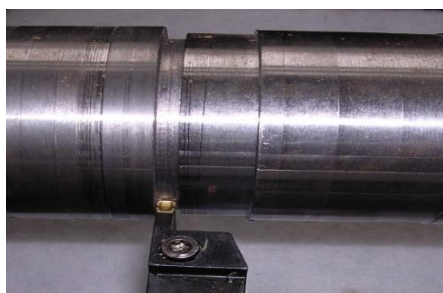
Slika 1.8. Tokarenje profila (utor)
