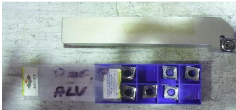
Slika 1.14. Prikaz alata za grubu obradu oznake SCLCR 2525M – 12 uz odgovarajuće rezne pločice u tvrtki „JLM Perković“
