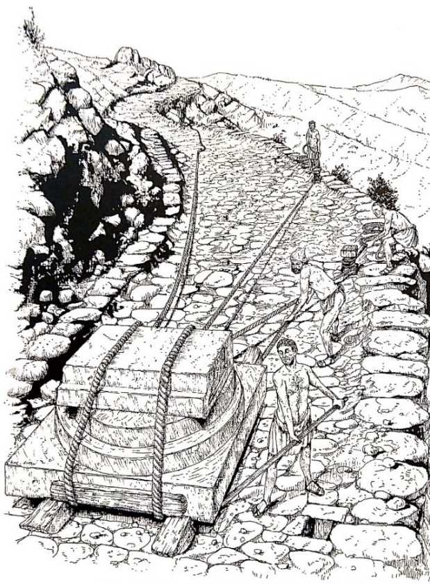
Slika 18 - Crtež rekonstrukcije sustava transporta kamenih predmeta pomoću konopa i greda (Bruno 2002, 185, sl. 8)
