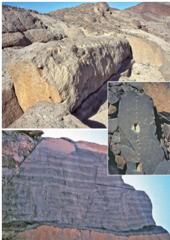
Slika 11 – Rimska tehnologija vađenja tvrdog kamena. Gore: napušteni stup u kamenolomu Mons Claudianus , još uvijek pričvršćen za stijenu, s tragovima rupa u obliku klinova i urezanim žlijebom duž donjeg ruba. Sredina: kameni blok u kamenolomu Wadi Hammamat, s rupama za klinove i pointillé rupama. Dolje: klesano lice porfirne stijene u kamenolomu Mons Porphyrites gdje su blokovi vađeni u više slojeva (Harrell – Storemyr 2009, 27, sl. 17)
